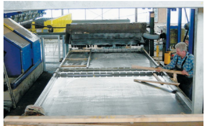
Die Palettenumlaufanlage: Nachdem der Grundriss des Deckenelements aufgeplottet ist, schalt ein Mitarbeiter an dieser Station ein.
