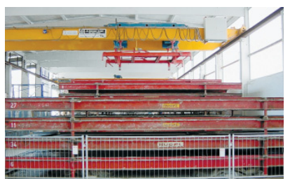
Nach dem Betonieren: Die Paletten mit den Deckenelementen werden zum Aushärten von einem Automatikkran eingestapelt.
