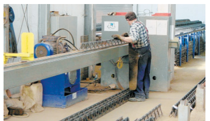
Nur noch wenig Handarbeit: Hier werden die Gitterträger abgelängt. Der Einbau der Stahlbewehrung läuft ansonsten automatisch.
